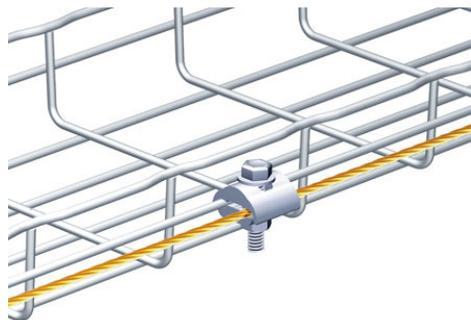
El tendido del cable de tierra deberá estar libre de uniones en toda su trayectoria y en el extremo de la charola del lado del rack de comunicaciones deberá dejarse una punta de 10 metros de longitud a efectos de conectarlo posteriormente a las barras de tierras físicas.
