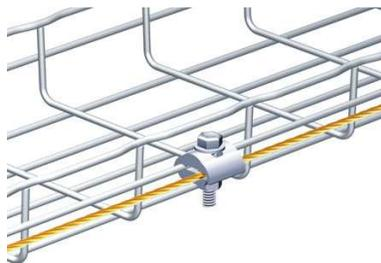
El tendido del cable de tierra deberá estar libre de uniones en toda su trayectoria y en el extremo de la charola del lado del rack de comunicaciones deberá dejarse una punta de 10 metros de longitud a efectos de conectarlo posteriormente a las barras de tierras físicas.
