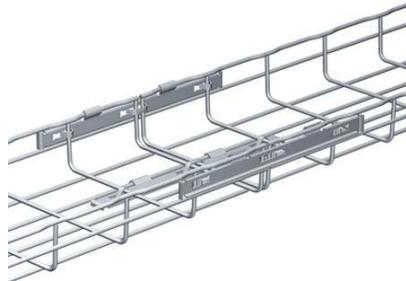
Las uniones que sean necesarias efectuar en la elaboración de curvas o uniones tipo “T” se efectuarán con tornillos de tipo CE25/CE30, manufacturados, probados mecánicamente y provistos por el fabricante de la charola que se provea, dependiendo del tipo de canalización. Se utilizarán 3 de estos accesorios de unión rápida por cada unión de tramos de charola que se realice.
